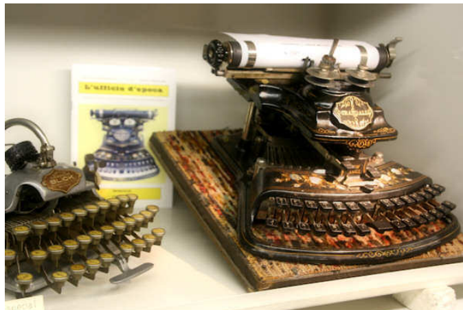
Crandal - portacaratteri a cilindro mobile
